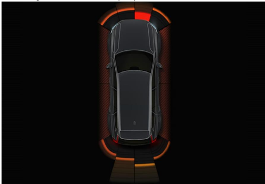
Bildskärmsvy med hinderzoner och sensorsektorer.
