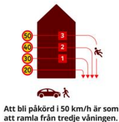
Figur 3 Bilden visar jämförelse mellan rörelseenergi (bli påkörd av bil i x km/h) och lägesenergi (fälla från våning Y ). Bild: Trafikverket
